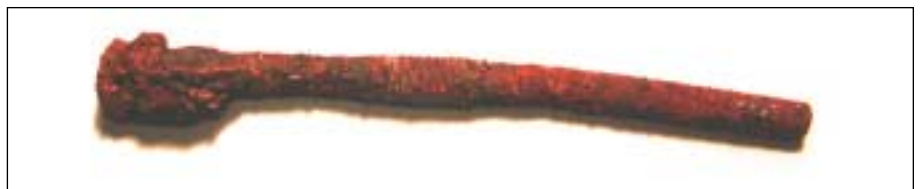
Voorbeeld: volumetoename koolstofstaal ten gevolge van roest en werkelijke dikte materiaal M6 draadstang afname dikte 0,3 mm.
