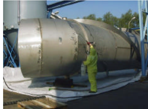
Nog een voorbeeld van het sproei-beitsen van een (zeer) groot object (26 meter lange schoorsteen)
