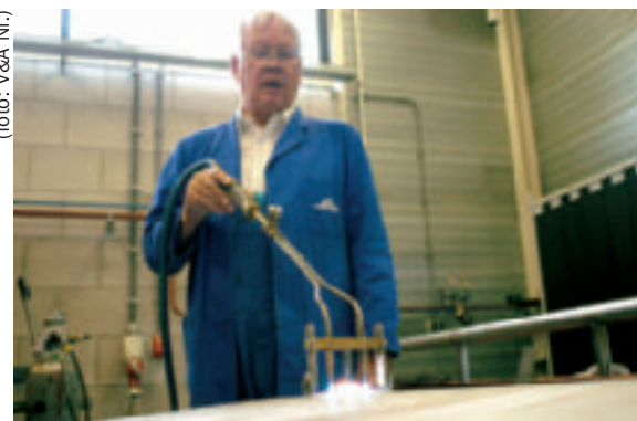
Koelen en verhitten van een werkstuk is een kunst op zich, zo toonde Klaus Schumacher aan. Bij plaatwerk is het raadzaam om het verwarmen van een werkstuk puntsgewijs te beginnen of gebruik te maken van lijnverwarming.
