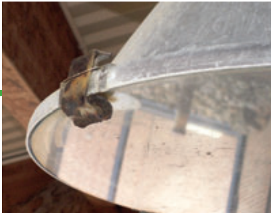
Verroeste rvs-klem op zware glasplaat.
