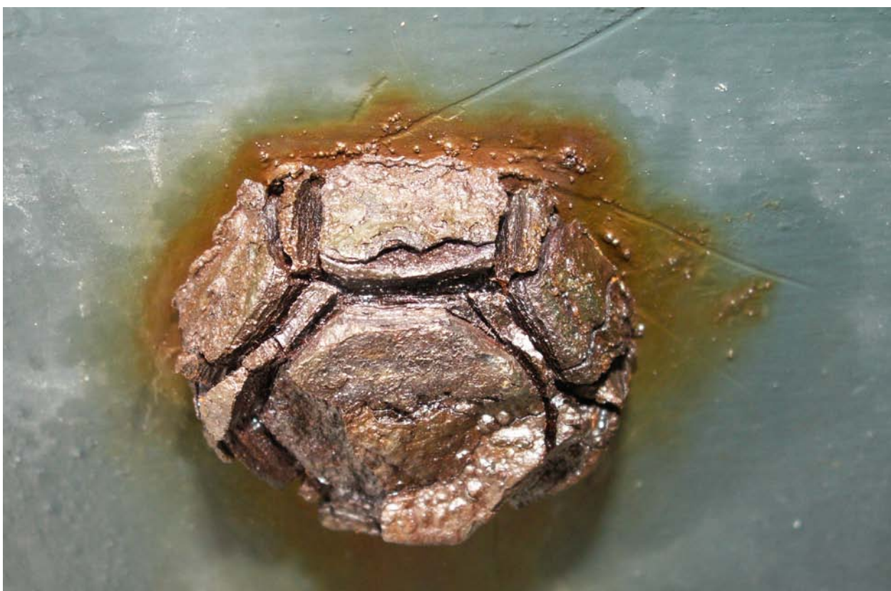
Geen RvS maar koolstofstalen bouten vergaan zichtbaarder in het milieu van binnenzwembaden
