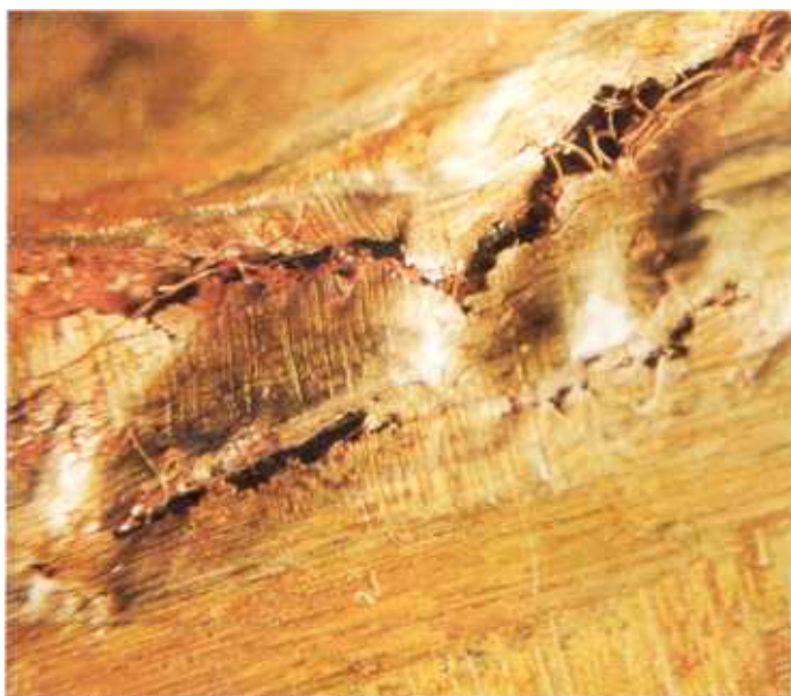
2. Detailopname van een scheur in roestvaststaal door spanningscorrosie.
