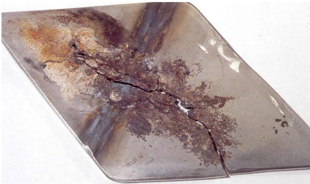
Spanningscorrosie van Roestvaststaal AISI 1.4435 in een inspuitskanaal van calciumchloride.
