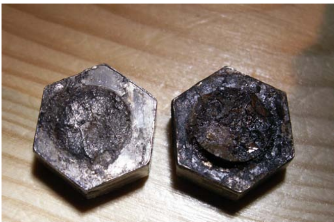
Koppen van M24 bouten afgebroken lagen in de plantenbakken
