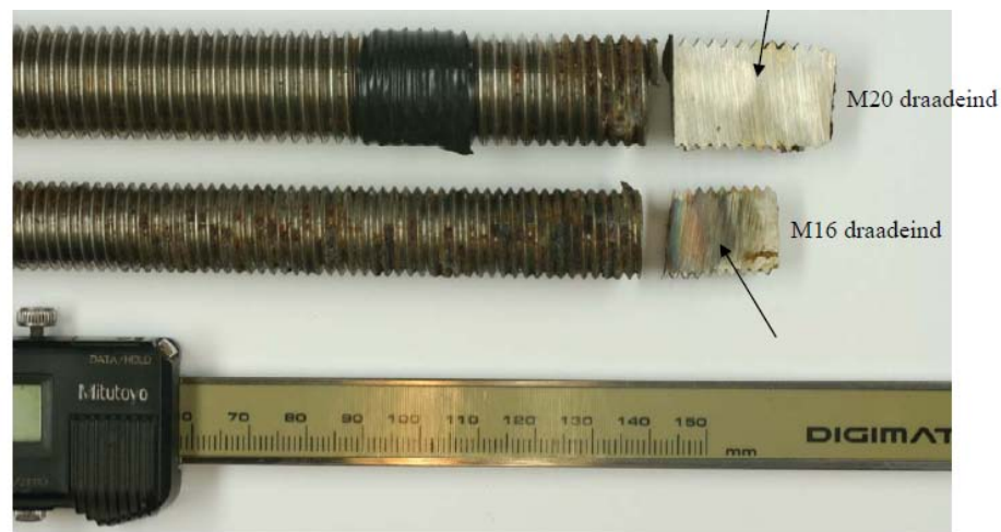
Figuur 1. Deel van de 2 draadeinden. De pijlen wijzen naar de posities van de langsdoorsneden die zijn geprepareerd voor macroscopisch- en lichtmicroscopisch onderzoek.
