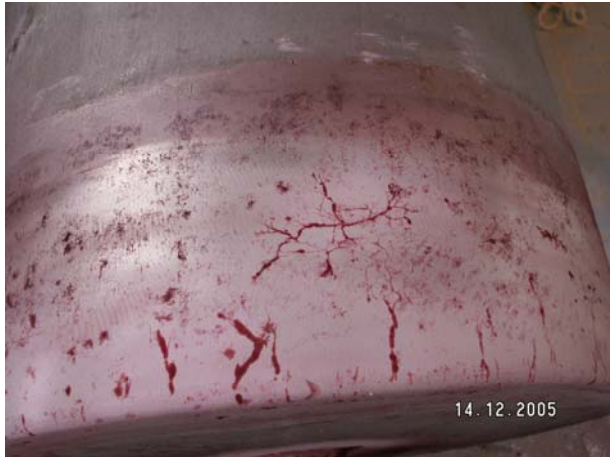
Rol vol met scheuren (geconstateerd met check methode met penetrant vloeistof)
