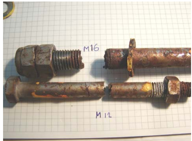
Reeds gebroken RvS bouten glijbaan
