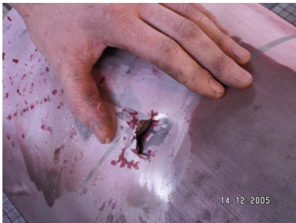
Monteur geloofde niet dat scheuren door en door waren, daarom met hamertje op scheur geslagen
