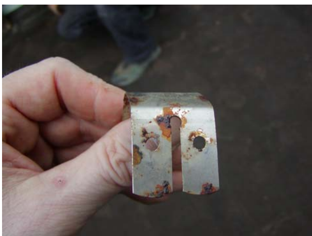
Roestvaststalen plaatjes vol met spanningscorrosie scheuren
