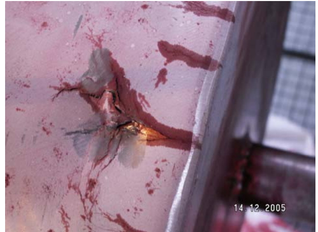
Rol vol met scheuren (geconstateerd met check methode met penetrant vloeistof)
